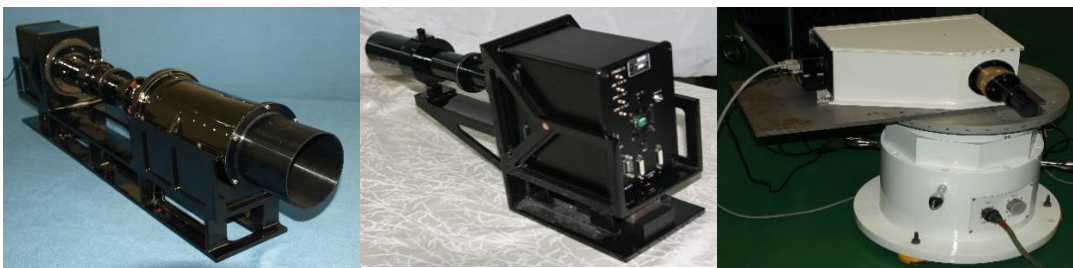
图 1.1 自行设计研制的具有自主知识产权的成像光谱仪星载、机载样机
